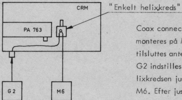
Coax connectoren på PA763 aftages og monteres på M6, hvorefter generatoren G2 tilsluttes antenneterminalen på CRM-siden. G2 indstilles nu på 468MHz, hvorefter helixkredsen justeres til minimum udslag på M6. Efter justeringen genetableres forbindelsen mellem sugekredsen og PA763 og skærmændæksel og låg påsættes.
