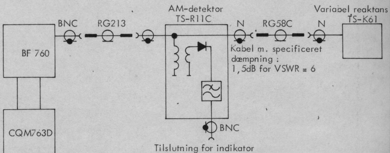
Ustabilitet i senderen viser sig som bekendt ved AM modulation af den udsendte bærebølge, med en modulationsfrekvens der kan variere fra ca. 0,5 til 40MHz på 450MHz. Påvisning af parasitiske svingninger sker derfor med en detektor efterfulgt af et filter, der fjerner bærebølgen, samt en indikator, der kan være
